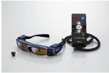
世界でも稀な夜盲症と視野狭窄の方を対象とした眼鏡型のウェアラブル機器です。HOYA が独自開発した小型低照度高感度カメラで捉えた像を明るい映像として着用者の左右の目の前に配置された有機 EL ディスプレイに投影します。赤外線カメラと違い、暗所でのわずかな光を増幅させているので、対象物の色彩を自然に再現します。
